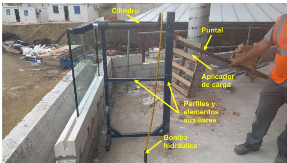
Fotografía 1.- Colocación de equipo
